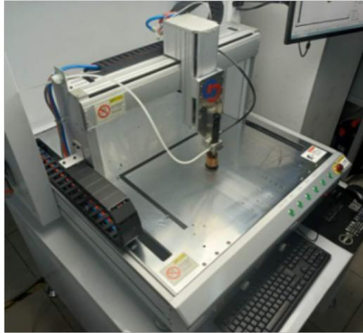
自动涂胶机是一个典型的机电一体化系统。所谓的机电一体化系统是指在系统的主功能，信息处理功能和控制功能等方面引进了电子技术，并把机械装置、执行部件、计算机等电子设备以及软件等有机结合而构成的系统。自动涂胶机系统是在机械、执行、信息处理、接口和软件等部分在电子技术的支配下，以系统的观点进行组合而形成的一种新型机械系统。全自动涂胶机由机械系统(机构)、电子信息处理系统(计算机)、动力系统(动力源)、传感检测系统(传感器)、执行元件系统(如电机)等五大子系统组成。
